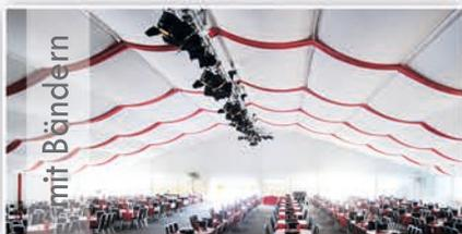
**DEKOHIMMEL** - Textile Stoffbahnen werden in einem Zelt oder einer Halle auf Draht in verschiedenen Ausführungen montiert, um die Unterkonstruktion sowie technische Einrichtungen nicht nur zu verdecken, sondern auch, um ein klares, einheitliches und neutrales Gesamtbild zu erhalten.
